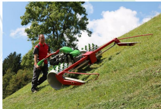
Figure 2 : Motofaucheuse à cylindre à pointes (Rapid CH 2022)
