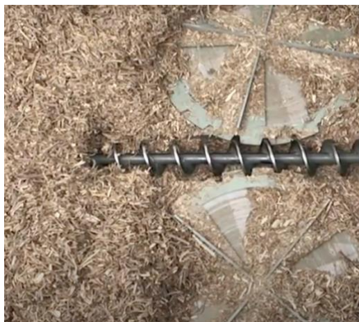
Figure 4. Vis sans fin d'une chaudière à sarments. Source : Oonyx.
