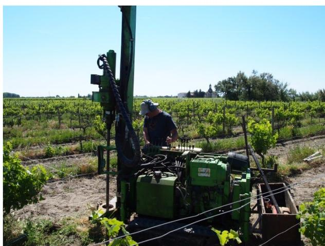
Figure 18 Forage pour la pose d'un piézomètre sur le domaine Le Pive
