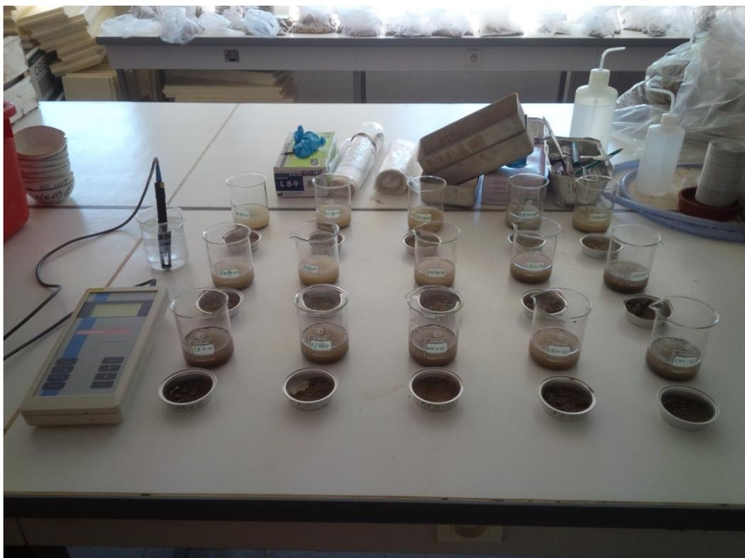
Figure 4 Mesure de la conductivité électrique sur échantillons dilués au 1/5e.
