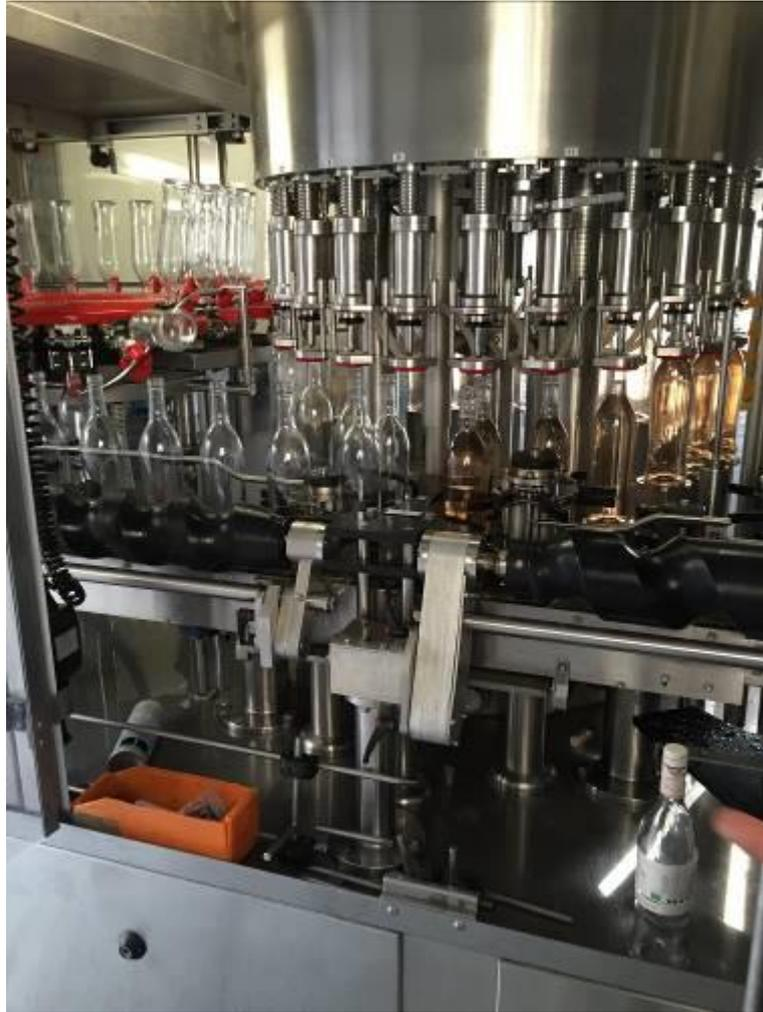
Figure 4 : Rinçage et remplissage des bouteilles
