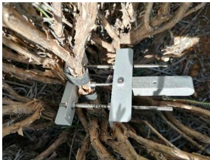
Figure 8 : Dendromètre installé sur l'une des parcelles du réseau, Source : SCP
