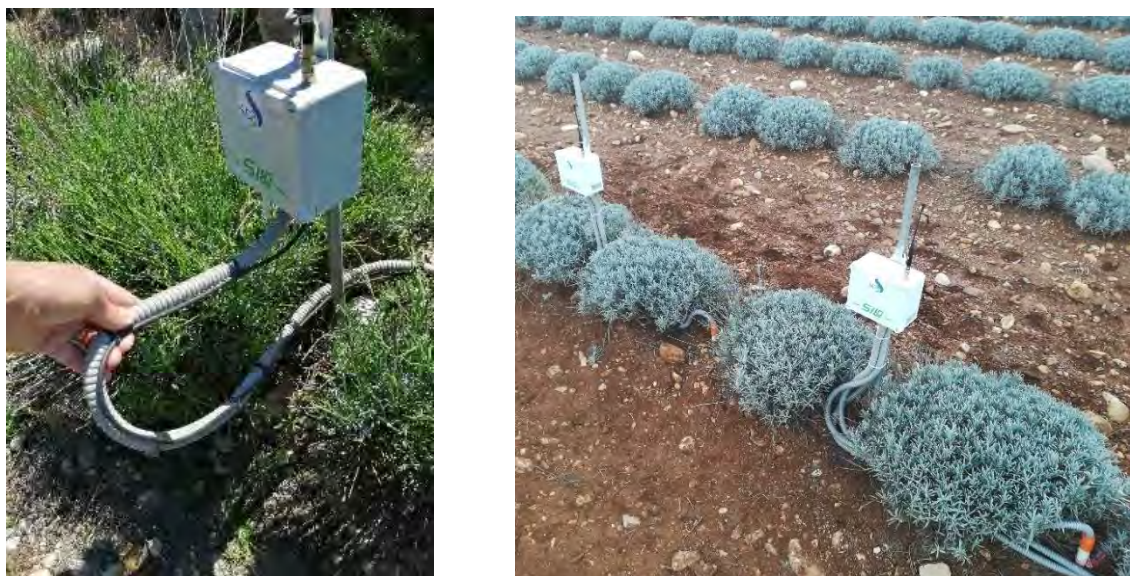
Figure 7 : sondes tensiométriques reliées au Silo sur une parcelle du réseau, Source : photo SCP
