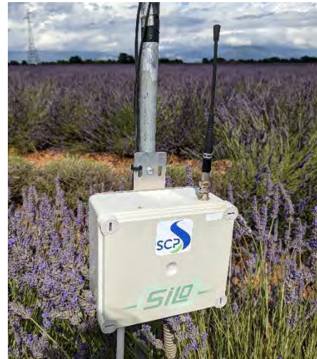
Figure 6 : Station agro-météo installée sur le rang d'une parcelle du réseau. Source : photo personnelle
